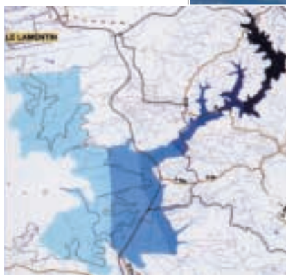
Simulation de propagation de l'onde de rupture du barrage de la Manzo.
